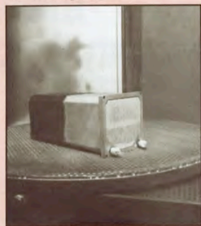
A partially PMB-stripped aircraft instrument housing. Un carter d'instrument de bord partiellement décapé par média plastique.
