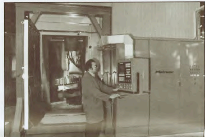
The new Matrasur shot peener at SNECMA, Corbeil. La nouvelle grenailleuse de pré-contrainte MATRASUR chez SNECMA,
